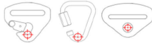
Beispiele von Anlenkungen der Gurtbefestigung
