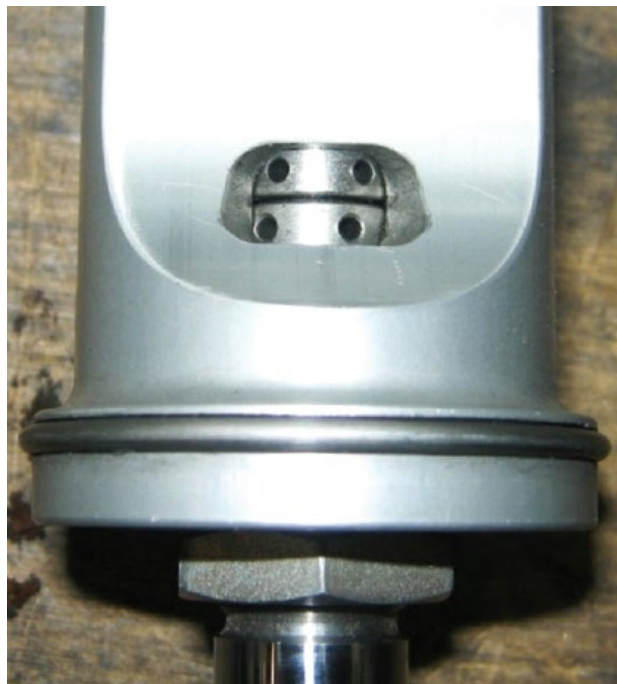
Doppelt einstellbare Einrohrbauweise
