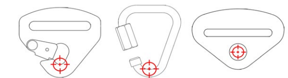
Beispiele von Anlenkpunkten der Gurtbefestigung
